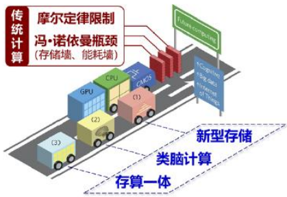
图 1-2 冯·诺伊曼架构和新型存储-计算架构对比示意图
